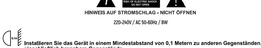
Installieren Sie das Gerät in einem Mindestabstand von 0,1 Metern zu anderen Gegenständen, einschließlich brennbare Gegenstände.
